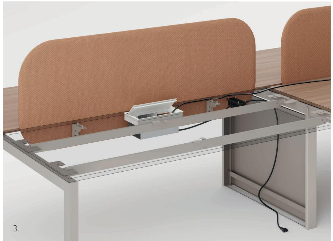
IT – 3 e 4. Scrivania bench e tavolo riunione: la gamba metallica centrale condivisa ha due carter a chiusura per la canalizzazione verticale dotati di magneti per facilitarne la rimozione. I cavi sotto piano vengono raccolti da cable grip fissati e da una vaschetta multipresa da integrare al Profcable per la fuoriuscita dei cavi sul piano.
